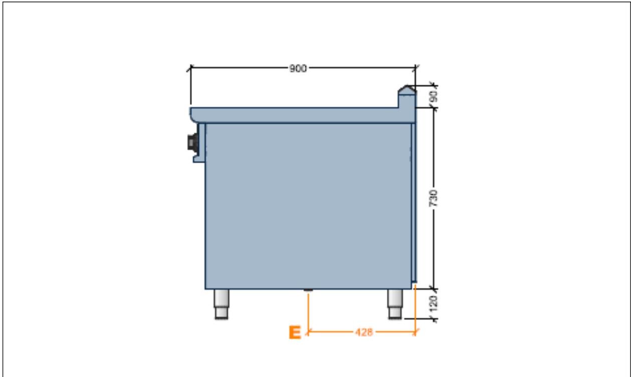
Fig. 16 Dimensioni cucina piano in vitroceramica
