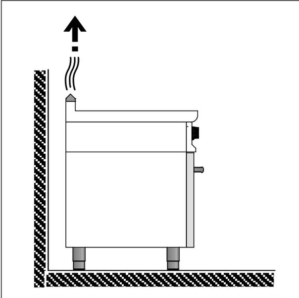
Fig. 22 Scarico calore
